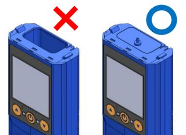
センサーユニットが挿入されていることを確認する(出荷時はセンサーユニットが装着されています)
