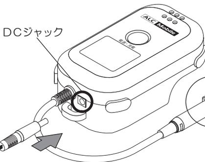
ALC-Mobile下部のDCジャックにACアダプター（DC12V）を接続します。
