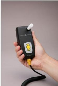
③センサーの前面にある決定ボタン（丸）を押します。インターロック全体の電源が入ります。カメラユニットが点灯し、「ウォームアップ中です」というアナウンスが流れます（II の場合、SD カードが挿入されていないと「メモリカードが検出できませんでした」というアナウンスが流れます。
