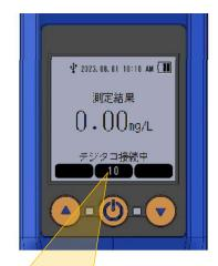
測定結果表示後 10 秒後に自動で電源 OFF します。
