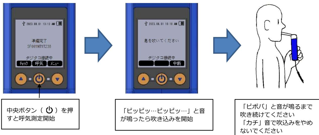
② 吹き込んだ呼気の強さが適正だと無音に切り替わります。呼気が強過ぎたり弱過ぎたりすると警告音「ピピピピピ…」が鳴り、限度を超えると以下のエラーとなります。
