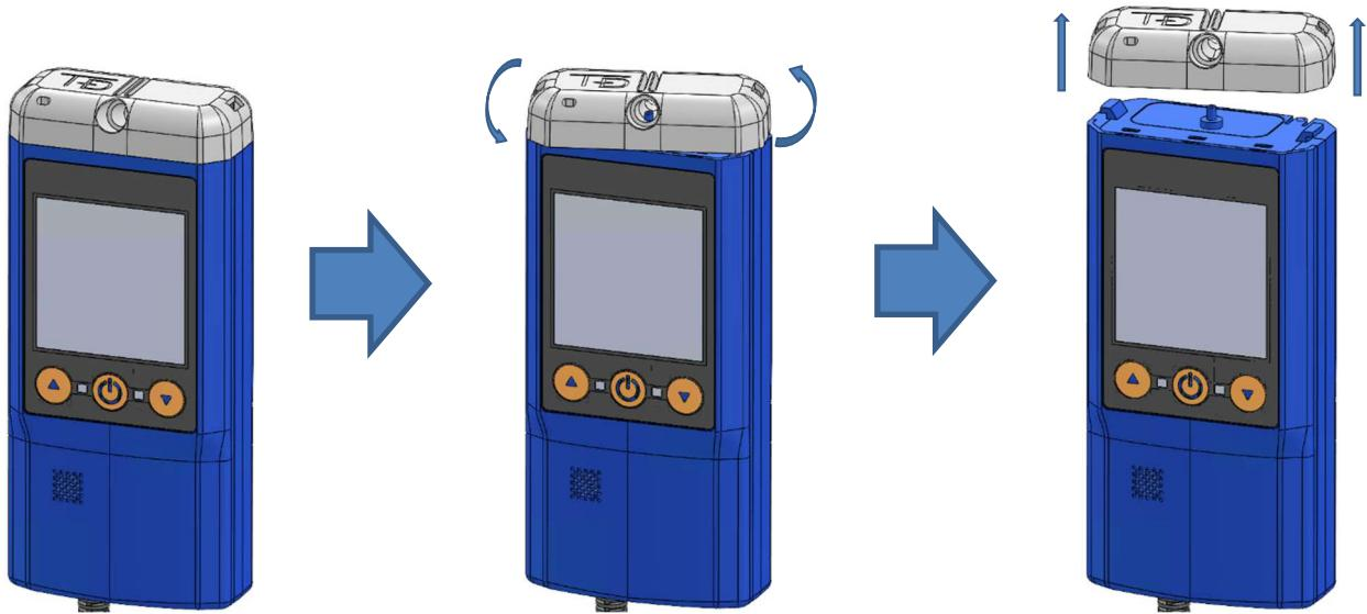
サンプリングチャンバー取り外し手順（取り付けは逆の手順で行います）。
