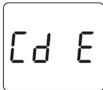
測定器内部温度が -6℃以下の時に表示されます。
