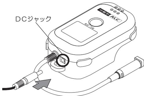
可搬型ALC下部のDCジャックにACアダプターを接続します。
